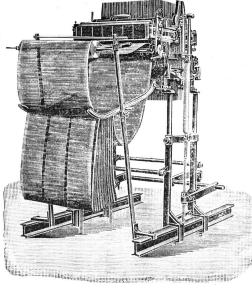
328 Automatische Kartenschlagmaschinen mit 1344 Stempel. D. R.-Pat. No. 103233.
