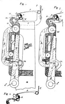
die Unterschiede in der Stärke der eingetragenen Schussfäden durch veränderte Schaltung ausgeglichen werden.
