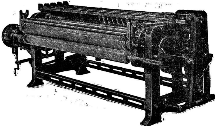
Ueber-Rreibmaschine gegen die Mittel reibend, mit Messerschlitzen. System Simonin.
