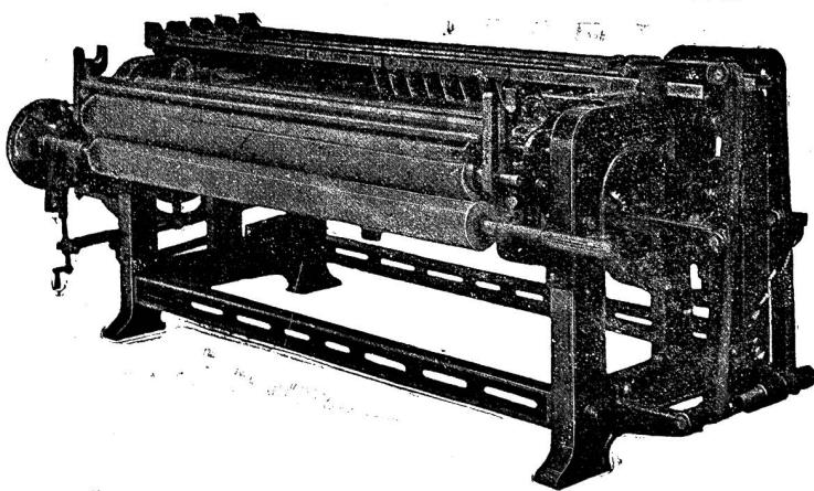
Die neue Röhrmaschine gegen die Ritterwebende mit Messerschlitzen System Simonin
