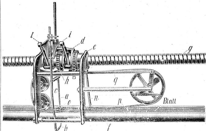
Wird nun durch den Tretmechanismus die Spindel g um etwa  $60^{\circ}$  gedreht, so wird dadurch auch der auf ihr nur gleitende, nicht aber verdrehbare Support d mit den Hebeln i und der Passette a, b, c entsprechend gehoben, wobei die Passette a samt Contrepassette in eines der Rohre hochgehoben werden.
