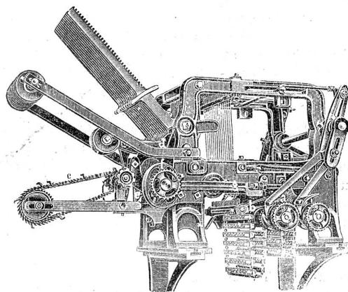
durch Vermittlung umschaltbarer Hülftasten, deren Umschaltung ebenfalls von einer Wechselkette aus besorgt wird, die nach beliebig grossen Schusszahlen vermittelst der vordersten Schwinge von den Musterkarten aus vorgerückt wird.
