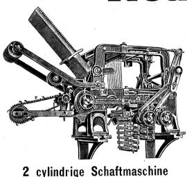
mit automatischem Bindungswechsel für abgepasste Gewebe. — Bedeutende Kartenersparnis, grosse Einfachheit und bequeme Handhabung. - Möglichkeit, nach beliebigen, ge-
