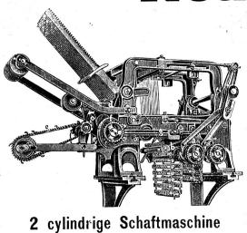
mit automatischem Bindungswechsel für abgepasste Gewebe. - Bedeutende Kartenersparnis, grosse Einfachheit und bequeme Handhabung. - Möglichkeit, nach beliebigen, geraden oder ungeraden Schusszahlen die Figuren abzubinden. — Je nach den Bindungen
