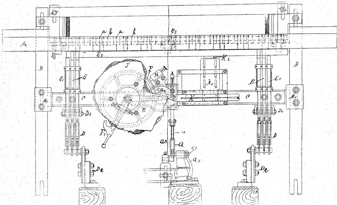
Brodirfäden sind auf leichten Bäumen aufgewunden, passieren zuerst eine Spannvorrichtung aus Aluminium und gehen dann durch Geschirr und unter der Lade hindurch in die Nadeln a der Brodirstäbe.
