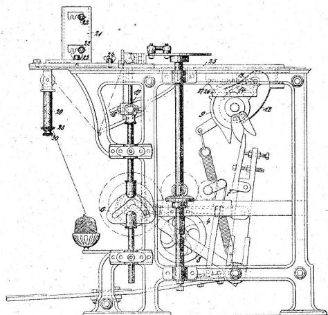
deren Drehung mit der Hand die Zahl der Fadenwindungen um den Cylinder 29 beliebig vermehrt oder vermindert wird, so dass dadurch jede in Frage kommende Spannung des Fadens einzustellen ist, die durch Anziehen der Mutter 30 gesichert wird. (B. T. Z.)
