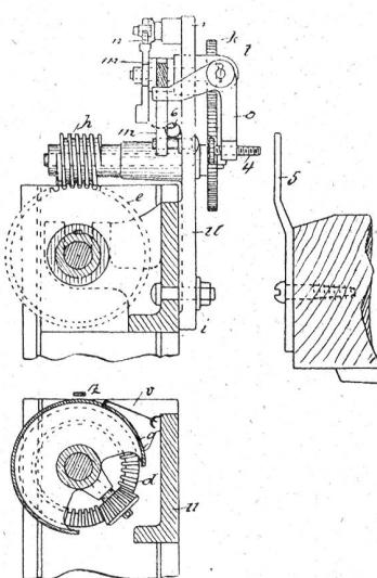
Der vorliegende Apparat bezweckt nun, die gerügten Uebelstände aufzudecken, er zeigt dem Weber automatisch und ununterbrochen von Anfang bis zu Ende des Webstückes an, ob die von dem Webstück aufgenommene Anzahl Schussfäden die beabsichtigte ist und markirt den kleinsten auftretenden Unterschied sofort deutlich auf einer Skalenscheibe.
