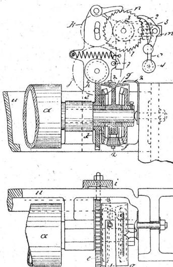
und einem in das letztere eingreifenden Schaltwerke. Die mit etwas gerauhtem Kautschouk überzogene Gewebe-Messwalze ist expansibel, d. h. es kann deren Umfang durch einfaches Verschieben etwas grösser oder etwas kleiner gemacht werden, um den Apparat auch für Bruchtheile von Schusszahlen, z. B.  $\frac{1}{4}$ ,  $\frac{1}{5}$  etc. Schüsse einzustellen.
