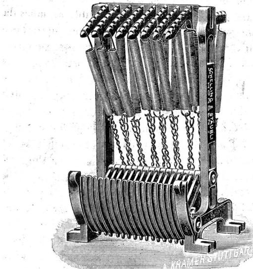
hat, dass die Zugkraft der Federn sehr einfach und genau abgestuft (7-fach regulirt werden kann. Dies kann durch verändertes Einhängen der Federn in die Einkerbungen der Zackenhebel (Rooststäbe) bewerkstelligt werden. Die Verwendung dieses Registers ist bei sogen. Lückenschäften (Streifengeschirren) von besonderem Vortheil.
