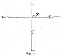
der Copirmaschine hochgezogen, so geht mit der Platine P auch ihr ausgesparter Einschnitt in die Höhe und die Knöpfe K können sich an die Platine anlegen. Die Stössel S sind ferner am geschärften vorderen Ende in einer Führungsplatte F gelagert, der eine zweite Platte F<sup>1</sup>, mit genau derselben Bohrung gegenübersteht. In den Zwischenraum Z wird das zu schlagende Kartenblatt eingelegt. Geschlagen wird das Blatt nur dadurch, dass mittels Umdrehung einer Kurbel
