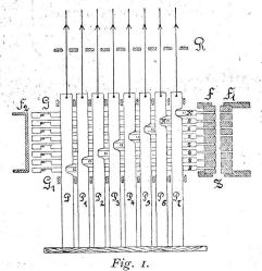
Platinen P den Stösselknöpfen K gegenüberstehen. An den Platinen P sind oben die nach den Sempern und der Copirmaschine führenden Schnuren befestigt, in welch' erstere das Muster eingelesen ist. Wird nun die Schnur vor dem Schlagen des Kartenblattes entweder mittels des Sempers von Hand oder mit Hilfe
