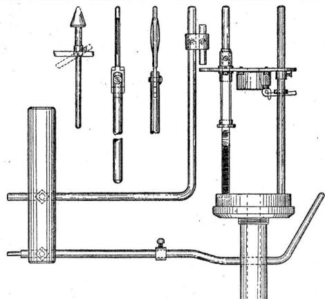
Die Charnierspindel ist an den neuern Spindeln so einfach und solid combinirt, dass sie auch nach jahrelangem Betrieb noch gut und sicher functionirt, also ein Wanken resp. eine Bewegung in seitlicher Richtung nicht mehr vorkommt.
