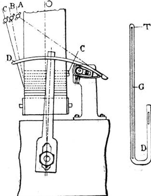
Dieselbe ist an ihrem Ende mit einem Auge T ausgestattet, welches mit einem im Schaft der Nadel verlaufenden Schlitz G in Verbindung steht. Die Schussfäden A B C von beliebiger Anzahl sind auf getrennten Spulen aufgewickelt, die an geeigneter Stelle des Webstuhles angebracht sind. Sie sind sämmtlich in den Schaftschlitz der Eintragnadel eingefädelt. Jeder der Figurenschussfäden ist in eine Litze eingezogen, die in geeignetem Augenblick durch die Karten gehoben wird.
