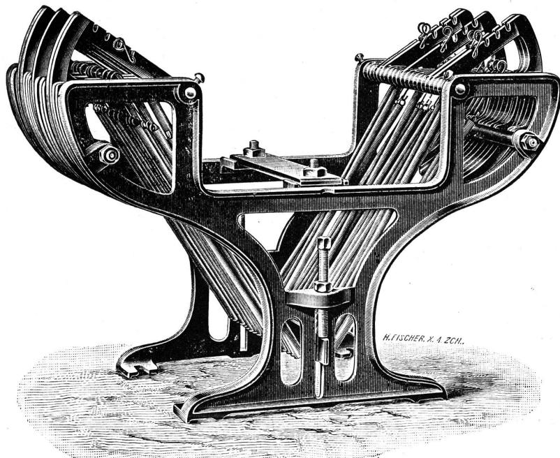
Schlingkanten-Apparate, welche gewöhnlich auf dem Boden festzuschauben sind, können leicht auf dem Register angebracht werden.
