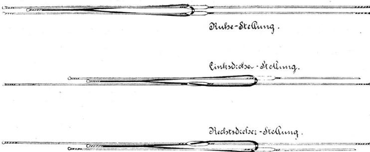
für grobe Ware aus starkem Stahldraht, für dicht eingestellte Artikel aus feinem Stahldraht verfertigt.
