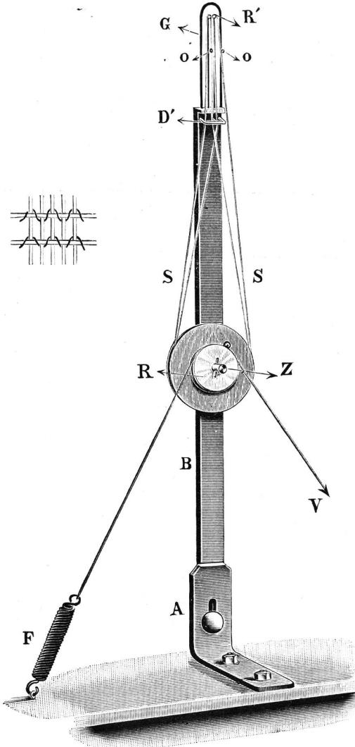
anhaften, nämlich, dass sie zu komplizirt und zu theuer ist. Der Schlingkanten-Apparat von J. Schweiter in Horgen ist dagegen, wie beistehende Figur zeigt, sehr einfach, er ist schnell und bequem zu montiren, von Seiten des Webers einfach zu handhaben, er stellt immerhin eine sehr solide Innenkante her und was ein Hauptvortheil ist, er kostet nur 8 Fr.
