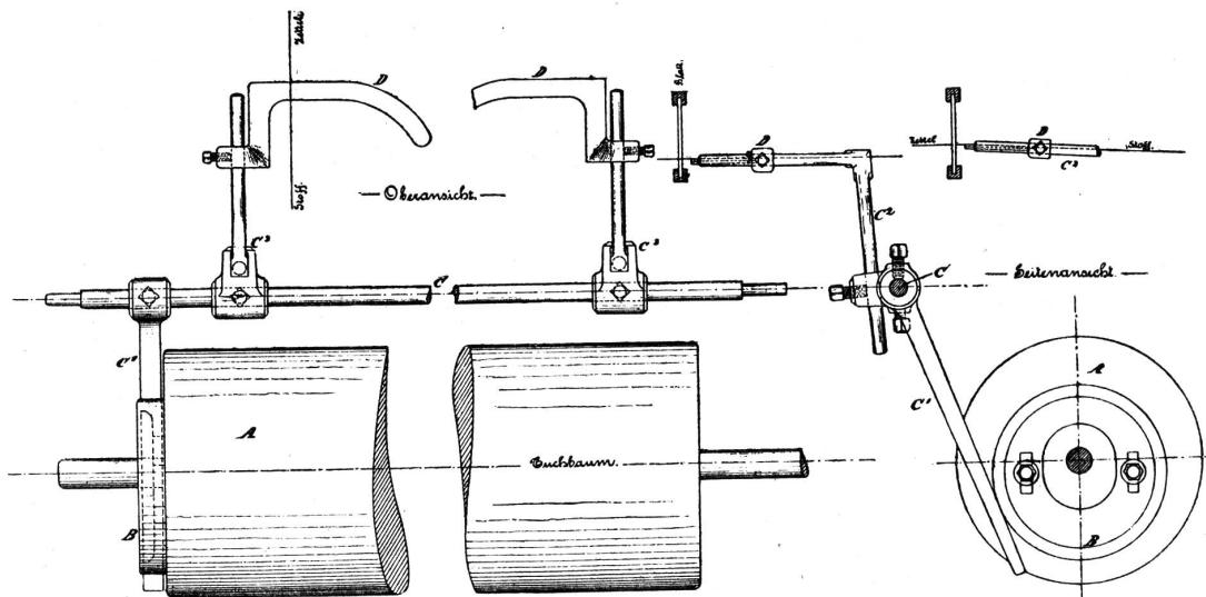
Hebung und Senkung des Gewebes, welche für den gewöhnlichen Gang des Stuhles, besonders den Schützenlauf, nicht nachtheilig ist. Die Oeffnung für die Achse des Tuchbaumes ist zudem ziemlich gross und oval und die Fixirschrauben der Scheibe befinden sich in
