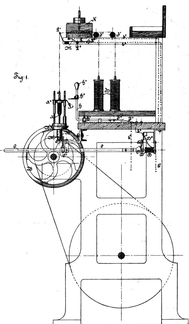
des Hebels C loslässt, so dass dieser niederfällt (Fig. 7). Hierbei schlägt der vordere Theil desselben an die Scheibe B<sup>3</sup>, hebt die Frictionsscheibe (Wirtel) B<sup>1</sup> und setzt diese also ausser Berührung mit der treibenden Scheibe B, so dass der Fadenführer zur Ruhe gelangt.
