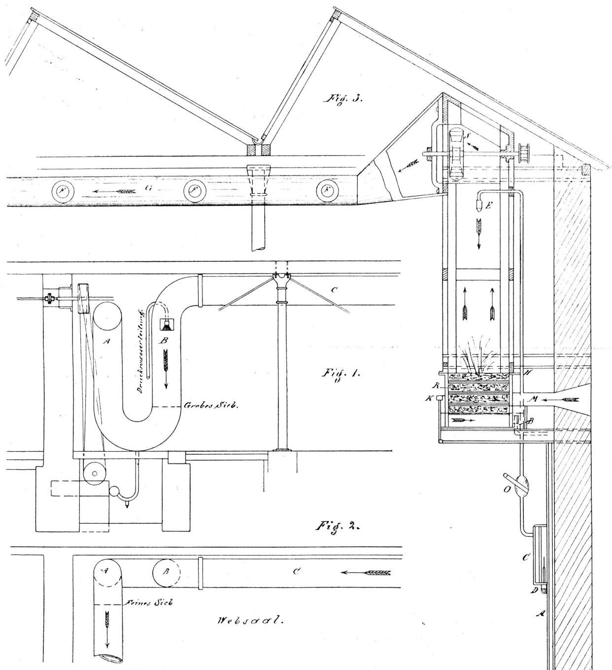
Staubkollektions-Anlagen, befasste sich ebenfalls schon viele Jahre mit speziellen Luftbefeuchtungs-Anlagen für Webereien und ist derselben in jüngster Zeit folgender durch Fig. 1 dargestellter Apparat patentirt worden:
