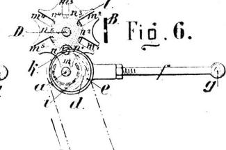
Beistehende Zeichnungen zeigen eine Ausführungsform der vorliegenden Erfindung, wobei A die Schilder, B das Nadelbrett, N die Nadeln und H die Platinen darstellen. In den Figuren 4, 5 und 6 sind zur Verdeutlichung der Arbeitsweise der Hauptorgane deren verschiedene Stellungen herausgezeichnet.
