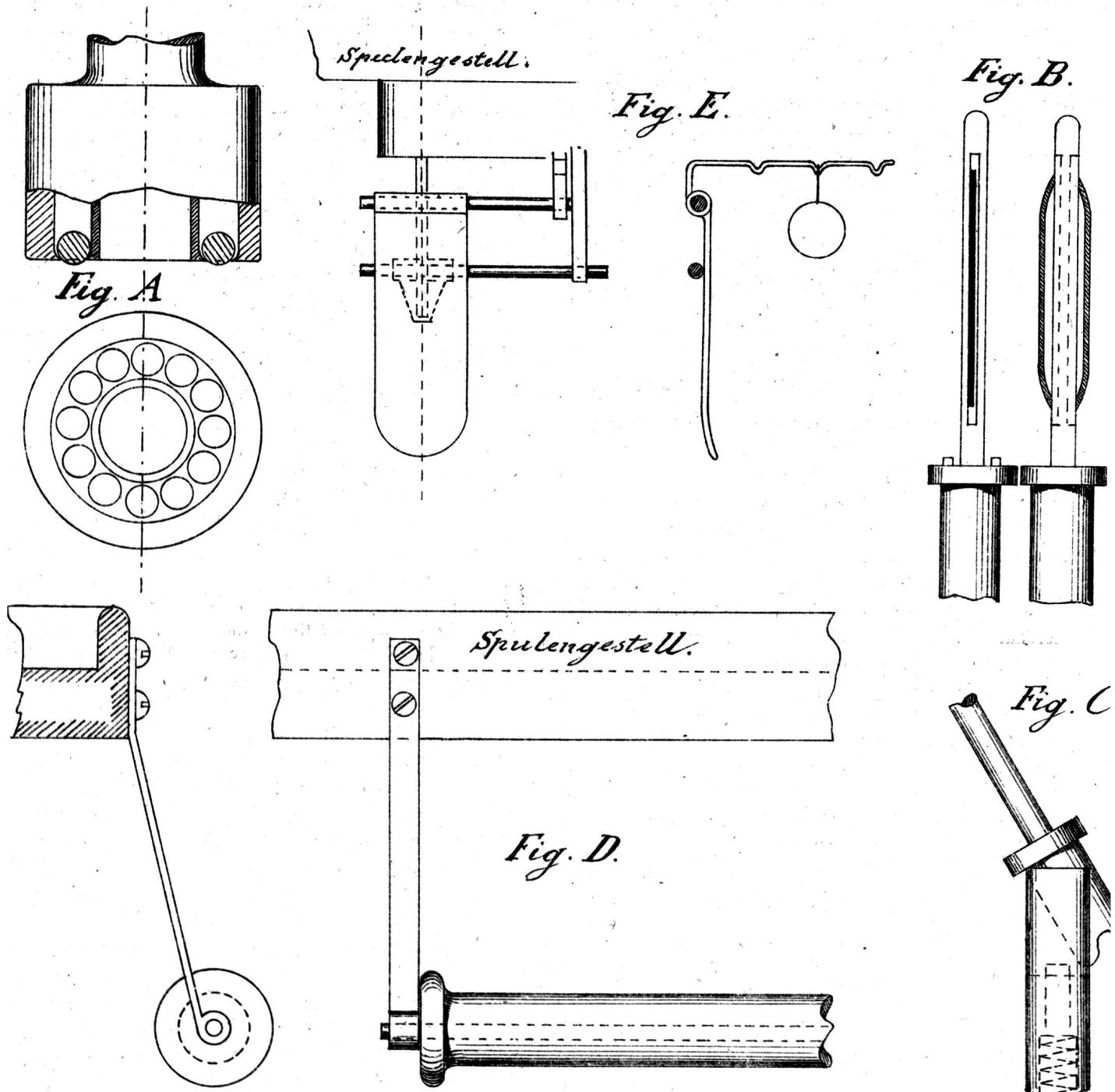
federn (schneiselartig) versehen, welche leicht auszuwechseln sind. (Figur B.)
