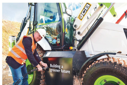
Le remplissage des bonbonnes s'effectue aisément en quelques minutes sur le chantier en actionnant une simple vanne.
