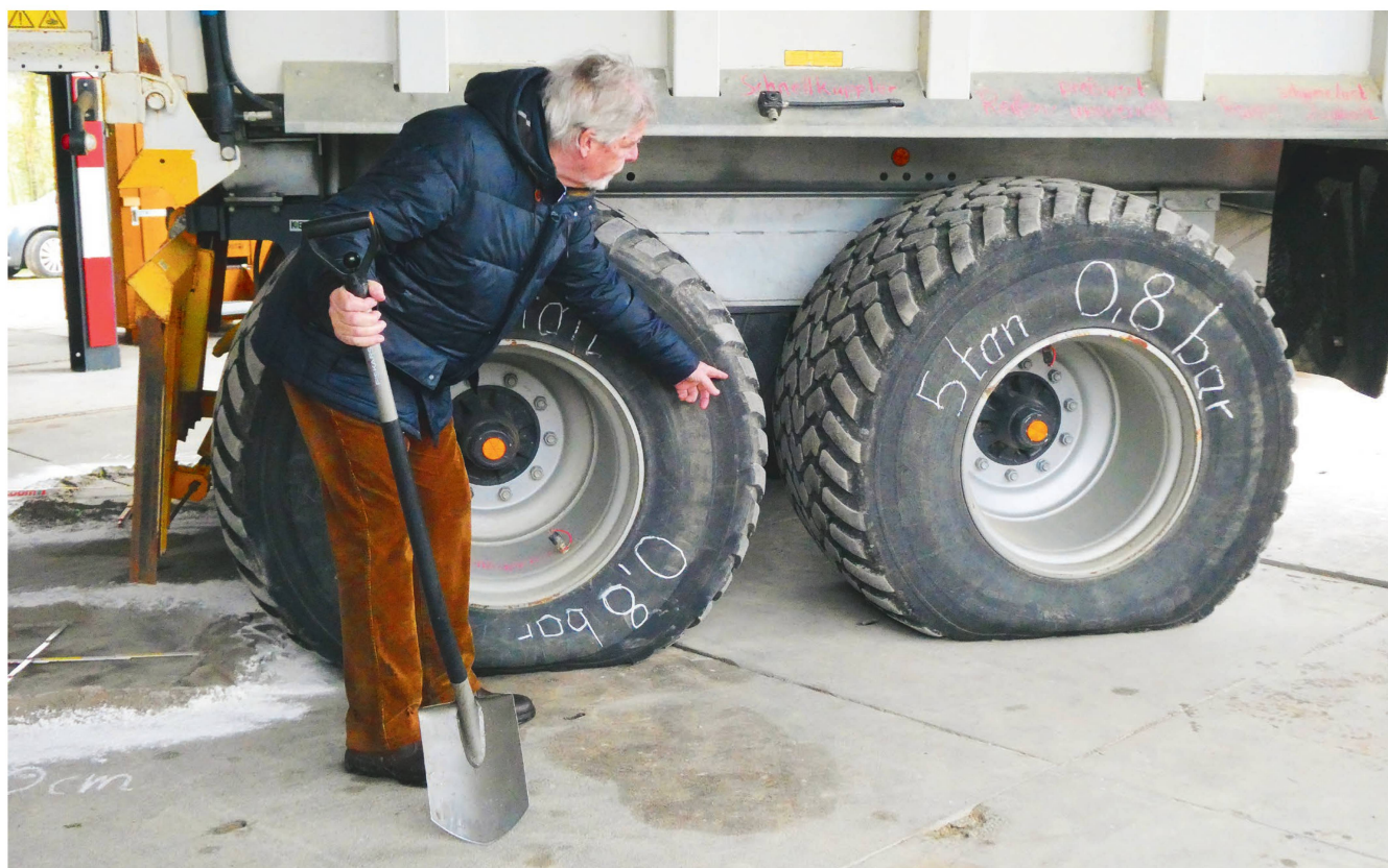
Ludwig Volk, pédologue à l'université de Soest: «Avec un chauffeur averti et une pression de gonflage au champ de l'ordre de 0,8 bar, on peut réduire sensiblement la consommation de diesel et préserver substantiellement le sol.» Photos: Ruedi Hunger
