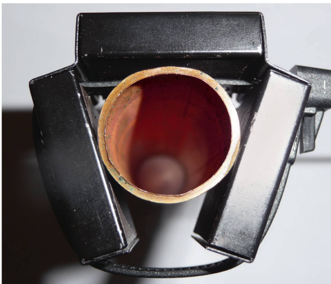
Les aimants permanents (ici visibles sur cette vue en coupe) sont positionnés de part et d'autre du conduit de carburant approvisionnant le moteur. Photo: Christophe Royer
