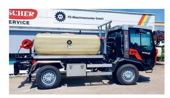
Une citerne de voirie de 2300 litres sur cadre à rouleaux, montée ici sur un transporter Reform muni d'un lift à crochet.
