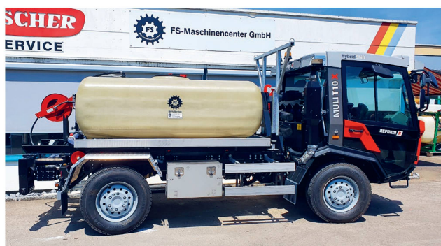
Une citerne de voirie de 2300 litres sur cadre à rouleaux, montée ici sur un transporter Reform muni d'un lift à crochet.
