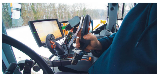
Le joystick monté sur la tringle s'apparente au levier multifonction intégré dans la console latérale droite équipant de série ce modèle.
