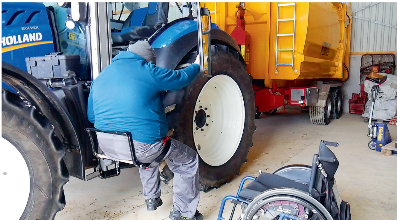
Une plate-forme rabattable munie d'un siège est fixée sur l'élévateur rotatif. Maik Näf l'utilise pour se hisser vers le tracteur et se sert d'une télécommande. Photos: Roman Engeler
