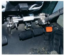
La pédale de frein installée dans la cabine est actionnée manuellement à l'aide d'une tringle spécifique.
