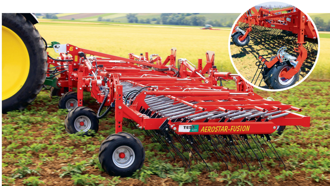
La machine de présérie «Aerostar-Fusion» a encore un problème de surpoids à régler. Einböck veut alléger son modèle de série et y optimiser certains détails. Les roues de jauge sont lourdes, et suivent bien le terrain.
