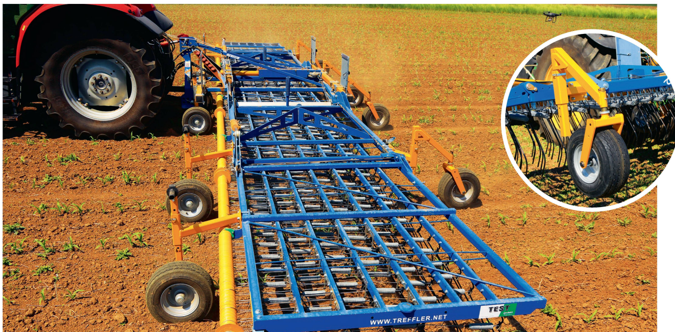
Le châssis de la Treffler «TS 1220 M3» est bien pensé et léger. Les roues arrière sont pourvues d'un dispositif de sécurité à amortissement mécanique. Les dents sont proposées avec un angle de 105 ou de 120 degrés ainsi qu'avec ou sans pointe en métal durci.
