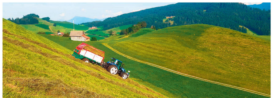
Sécurité assurée en descente aussi avec un essieu directeur-moteur («Lenktriebachse» de Urs Schmid).
