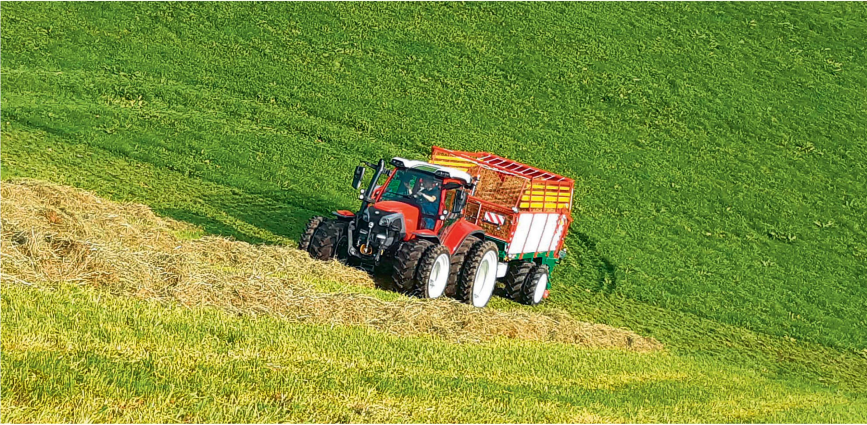
Grâce au timon articulé, l'entrée dans un dévers et le passage d'un épaulement du terrain deviennent possibles («X-Trailer» de Trachsel Technik).
