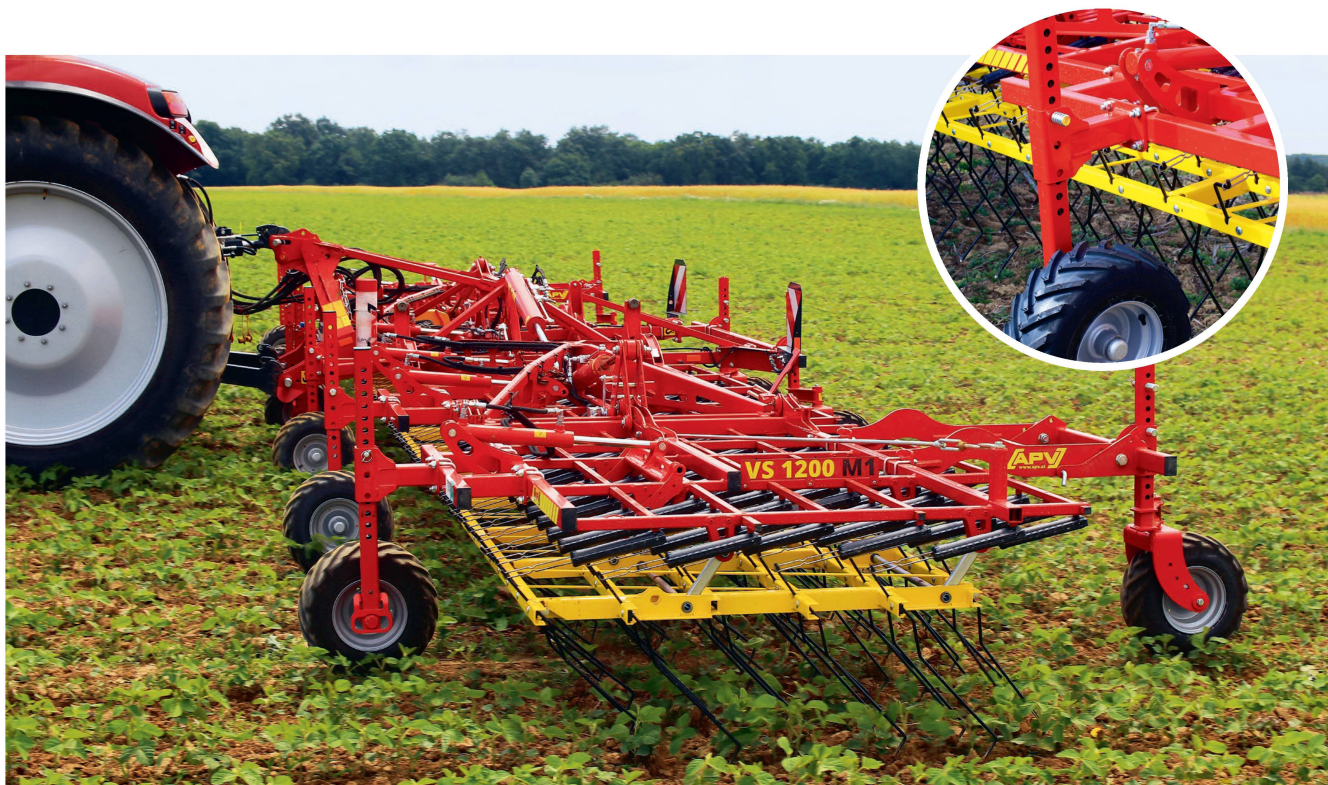
Le cadre de l'APV «Variostriegel», bien que léger, s'avère stable. Les roues de jauge se règlent bien en hauteur et en écartement. Le châssis jaune se déplace hydrauliquement vers l'avant ou vers l'arrière. Ainsi, l'inclinaison et la pression des dents varient.
