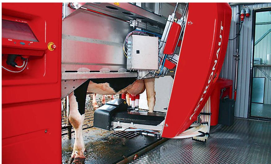
Les systèmes de traite automatiques (AMS) fournissent de nombreuses données de capteurs qu'il convient de mettre à profit. Photo: Lely
