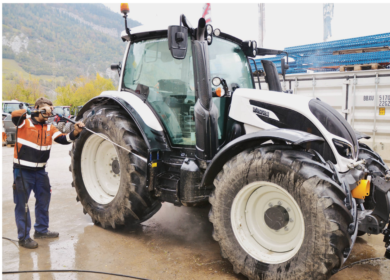
Les aires de lavage des machines et appareils doivent être étanches et disposer d'une évacuation vers la fosse à lisier. Photo: Kärcher
