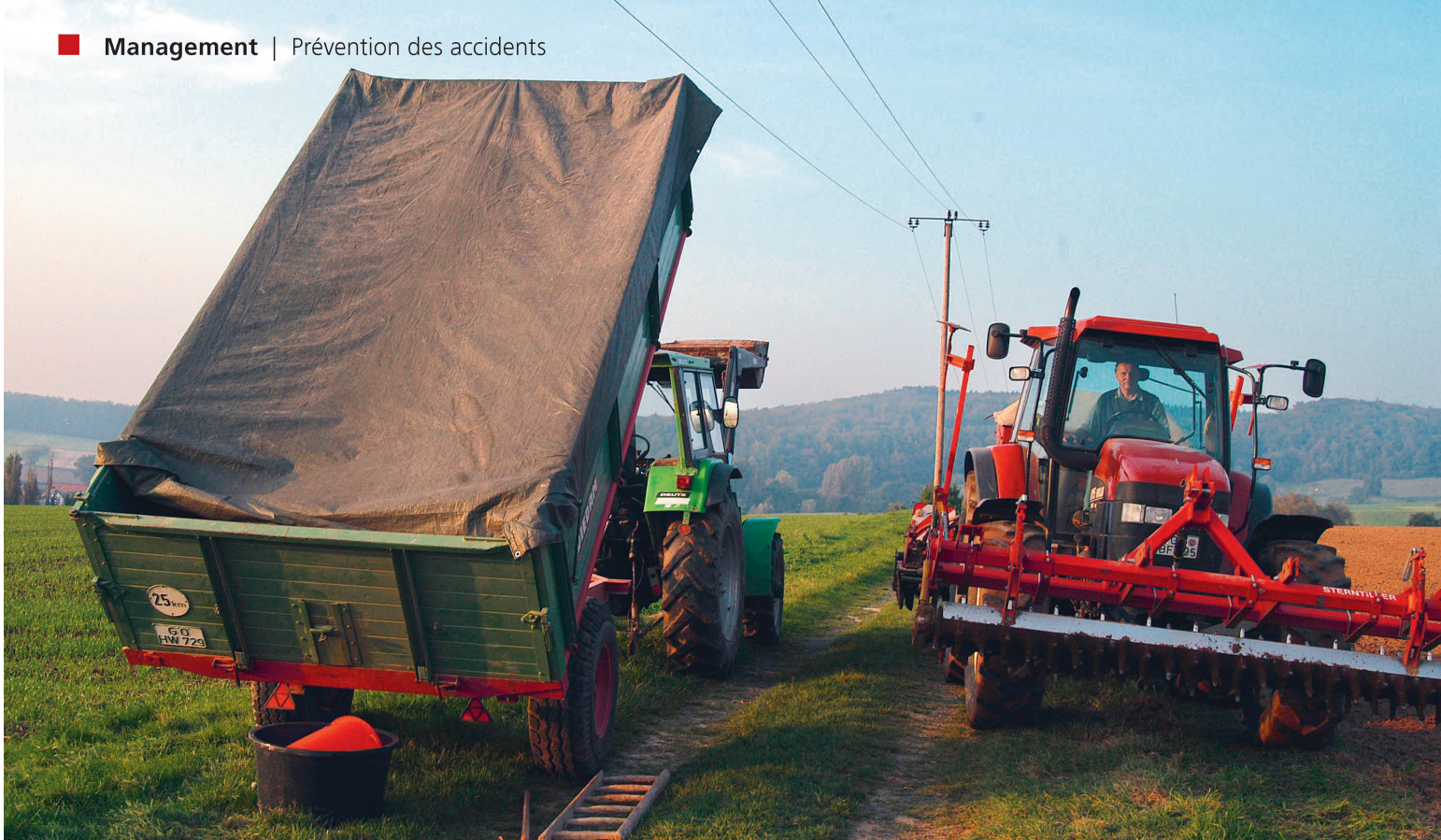
Une situation à proscrire! Les attelages sont trop proches de la ligne aérienne. Même sans contact, un arc aérien peut se former et il y a danger d'électrocution. Photo: landpixel.de
