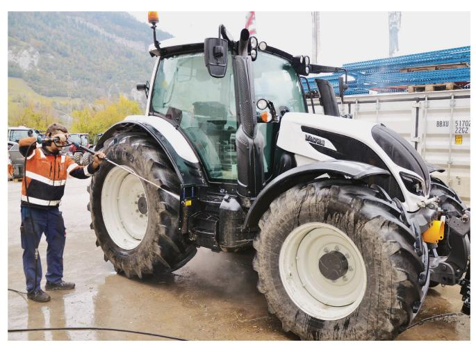
Les aires de lavage des machines et appareils doivent être étanches et disposer d'une évacuation vers la fosse à lisier. Photo: Kärcher
