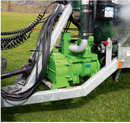
La pompe centrifuge de l'italien Battioni assure un débit de 7000 l/min.
