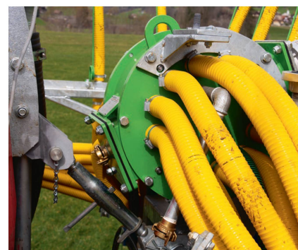
La tête de répartition à 24 sorties est fournie par le constructeur suisse Hochdorfer.
