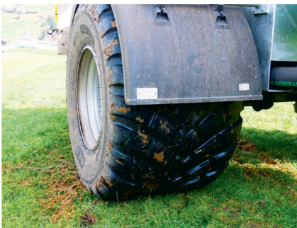
Pour préserver les sols, le choix s'est porté sur des pneus larges 710/45R22.5, généreusement dimensionnés.
