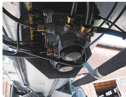
L'unité de commande du système de freinage multivoltage (12 ou 24 volts) est installée sous la citerne, devant l'essieu.
