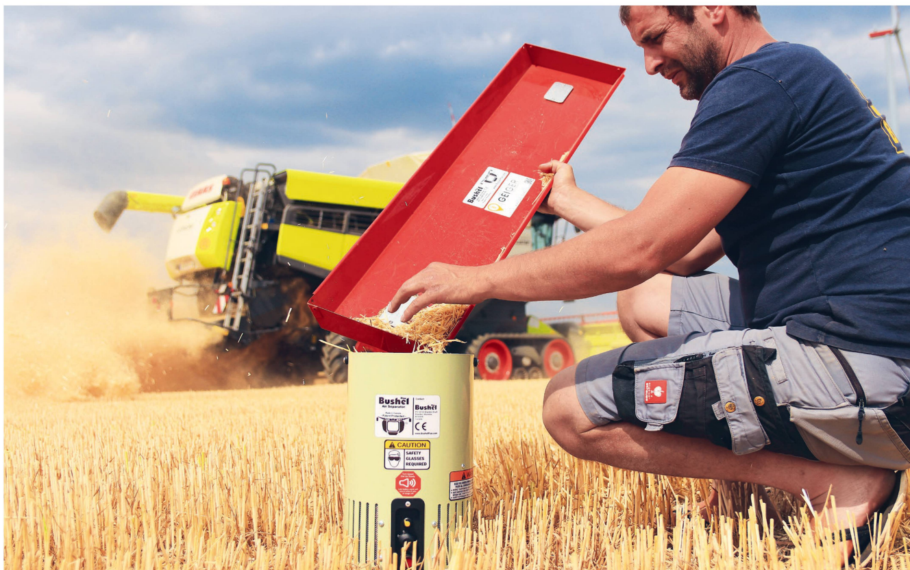
La soufflerie nettoie les grains perdus en éliminant les glumes et les menues pailles. Le nettoyage par le séparateur à air facilitera la tâche des utilisateurs qui auront pris le temps de se familiariser avec le système. Photos: Lukas Weninger
