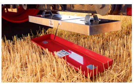
Le système de déversement (en haut) se fixe sur la moissonneuse-batteuse à l'aide d'aimants. Le plateau rouge y est arrimé grâce à des électroaimants.
