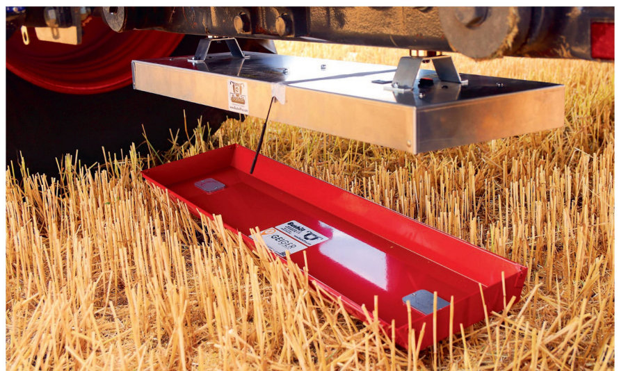
Le système de déversement (en haut) se fixe sur la moissonneuse-batteuse à l'aide d'aimants. Le plateau rouge y est arrimé grâce à des électroaimants.
