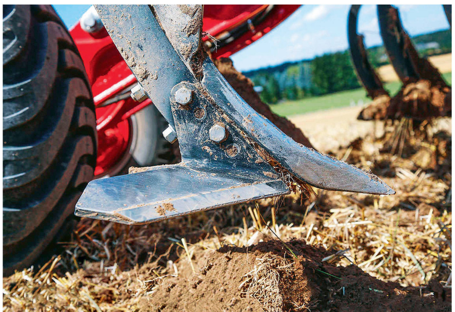
Les socs en métal dur ont une durée de vie supérieure, ce qui se répercute sur leur prix. Sur cette photo, un soc de chisel. Photo: Idd
