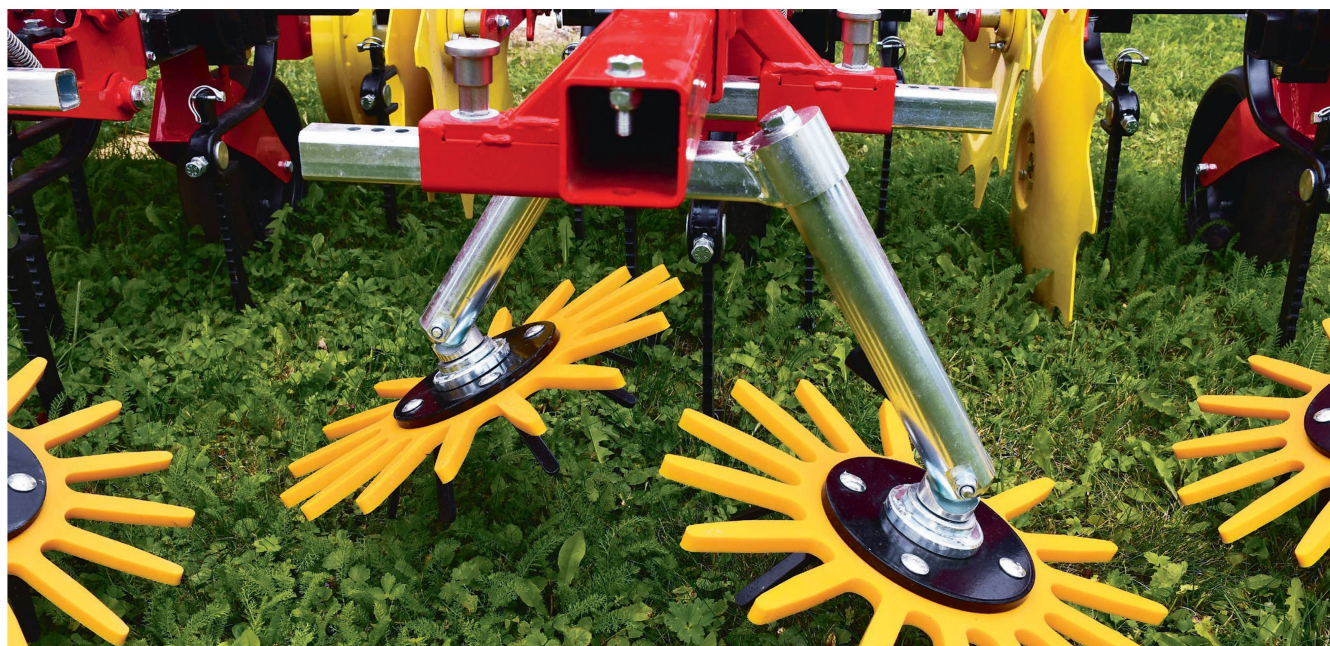
La «sarcleuse à doigts» est un élément supplémentaire permettant de maintenir propre la ligne de plantes. Photo: Ruedi Hunger
