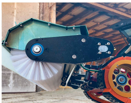
Les brosses sont toutes deux attelées au châssis par trois points autorisant un débattement transversal.
