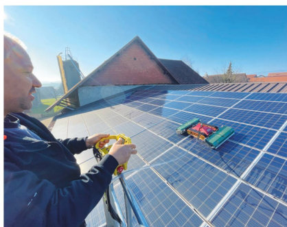
L'opérateur pilote par radiocommande l'appareil embarquant des batteries au lithium d'une autonomie de 4,5 à 5 heures.
