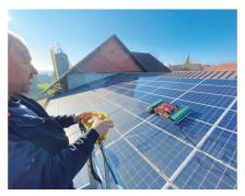
L'opérateur pilote par radiocommande l'appareil embarquant des batteries au lithium d'une autonomie de 4,5 à 5 heures.
