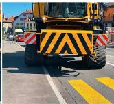
Pour traverser ce rétrécissement de chaussée, la moissonneuse-batteuse est contrainte de grimper sur le trottoir délimité par une bordure haute, à arête vive, susceptible d'endommager les chenilles en caoutchouc (ou les pneus). Photos: Laurent Vernez
