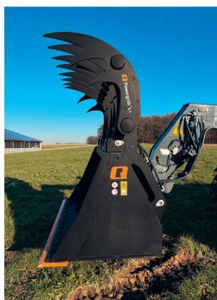
les chargeurs télescopiques et les chargeurs sur roues d'une capacité de 5 à 10 t. Il peut déplacer jusqu'à 3,3 m<sup>3</sup> en une prise grâce à son ouverture de 214 cm. Ces deux godets sont conçus pour une utilisation de long terme pour désiler à une fréquence de préhension particulièrement élevée. Ils contribuent à réduire les pertes au minimum. Avec leurs puissants vérins hydrauliques, ils peuvent manipuler de l'ensilage extrêmement tassé.
