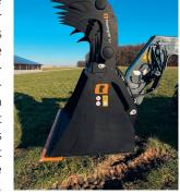
Grâce à son ouverture de 200 cm, il peut désiler jusqu'à 2,1 m³ en une seule prise. Le «Powergrab XL+» convient, lui, pour les chargeurs télescopiques et les chargeurs sur roues d'une capacité de 5 à 10 t. Il peut déplacer jusqu'à 3,3 m³ en une prise grâce à son ouverture de 214 cm.
