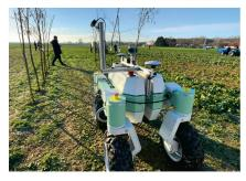
fixée sur un mât mesure avec une précision de 3 mm la section de chaque tronc. Pesant 250 kg, cet appareil tout-terrain dispose d'une suspension différentielle à axe central pour chaque côté, grâce auxquelles les roues restent toujours en contact avec le sol. Il se déplace à l'allure maximale de 5 km/h et navigue grâce au GPS RTK et via un Lldar dans la rangée.
