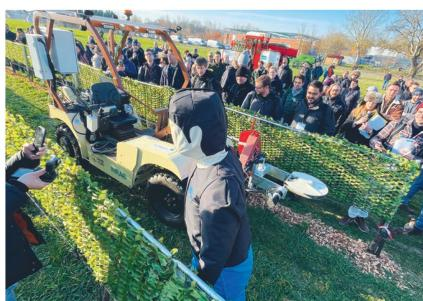
munie au choix de deux ou quatre roues motrices. Il est capable de travailler entre cinq et dix heures pour un temps de recharge de 1 h 30. Le modèle présenté était équipé à l'avant d'un Llidar multicouches capable de reconnaître et d'éviter les ouvriers agricoles évoluant dans son environnement, afin de travailler en cohabitation.
