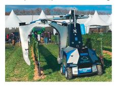
Il est équipé de porte-buses avec solénoïdes de type PWM à contrôle individuel. Le développement de l'automate «Weta Robot» a été soutenu par des fonds de I'UE dans le cadre du projet Scorpion.
