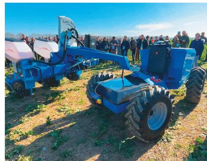
lente à celle d'un moteur diesel de 30 ch. Une pompe hydraulique alimente les vérins de direction et le relevage au niveau de l'outil. Le modèle présenté était équipé d'un semoir à disques pneumatique Monosem à trois rangs, attelé via un col de cygne. La commercialisation du «Softi Rover e-K18» est prévue dans cinq ans selon Softivert.
