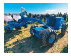
lente à celle d'un moteur diesel de 30 ch. Une pompe hydraulique alimente les vérins de direction et le relevage au niveau de l'outil. Le modèle présenté était équipé d'un semoir à disques pneumatique Monosem à trois rangs, attelé via un col de cygne. La commercialisation du «Softi Rover e-K18» est prévue dans cinq ans se-Ion Softivert.
