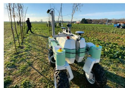
fixée sur un mât mesure avec une précision de 3 mm la section de chaque tronc. Pesant 250 kg, cet appareil tout-terrain dispose d'une suspension différentielle à axe central pour chaque côté, grâce auxquelles les roues restent toujours en contact avec le sol. Il se déplace à l'allure maximale de 5 km/h et navigue grâce au GPS RTK et via un LIdar dans la rangée.
