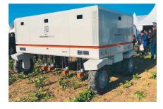
culture et aux dénivellations de la parcelle. Il assure la tonte de l'interrang, le semis ou le désherbage thermique par laser. Ses batteries amovibles de 13 kWh lui confèrent une autonomie de six à huit heures. Il est recouvert de panneaux solaires d'une puissance de 1,5 kW.
