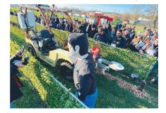
muni au choix de deux ou quatre roues motrices. Il est capable de travailler entre cing et dix heures pour un temps de recharge de 1 h 30. Le modèle présenté était équipé à l'avant d'un Lldar multicouches capable de reconnaître et d'éviter les ouvriers agricoles évoluant dans son environnement, afin de travailler en cohabitation.
