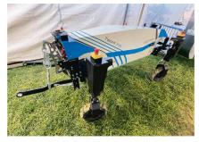
grâce à un double récepteur RTK GNS. Le guidage est affiné par caméra, détection de courbe et détection 3D. Grâce à des essieux télescopiques, la largeur de la voie s'ajuste entre 1,20 m et 1,60 m. Avec le châssis hydraulique, la garde au sol s'adapte au terrain. Le robot «Tipard 350» présente une autonomie de quatre heures.
