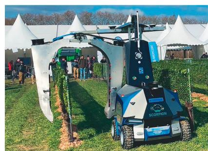
Il est équipé de porte-buses avec solénoides de type PWM à contrôle individuel. Le développement de l'automate «Weta Robot» a été soutenu par des fonds de l'UE dans le cadre du projet Scorpion. ■
