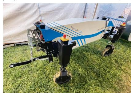
grâce à un double récepteur RTK GNS. Le guidage est affiné par caméra, détection de courbe et détection 3D. Grâce à des esieux télescopiques, la largeur de la voie s'ajuste entre 1,20 m et 1,60 m. Avec le châssis hydraulique, la garde au sol s'adapte au terrain. Le robot «Tipard 350» présente une autonomie de quatre heures.
