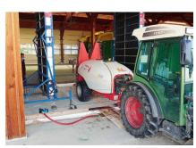
Un système de nettoyage intérieur automatique est obligatoire pour tous les pulvérisateurs d'une capacité de plus de 400 litres dès le 1er avril 2023. Photo: Idd
