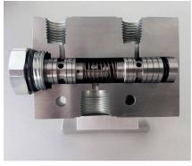
Un répartiteur/réunisseur de flux est une soupape fonctionnant comme une glissière et commandée par ressorts. Il répartit le flux d'huile entrant selon un rapport défini, identique ou proportionnel, indépendamment de la charge en deux flux partiels.
