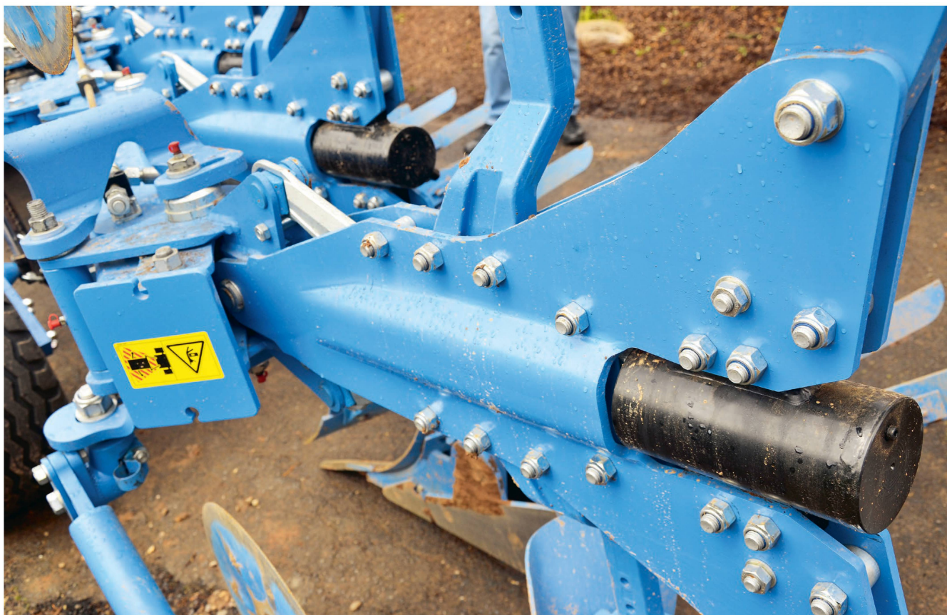
Chaque boulon est dimensionné selon des valeurs de charge possibles. Photo: Ruedi Hunger
