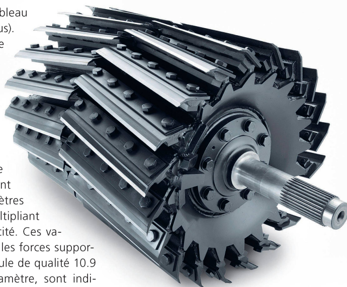
Malheur s'ils s'échappent! Les couteaux du tambour de hachage nécessitent, outre un couple de serrage correct, une sécurité supplémentaire. Photo: Idd
