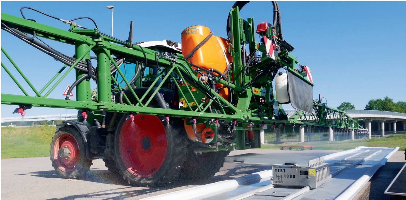
Les pulvérisateurs automoteurs et ceux entraînés par prise de force doivent être contrôlés tous les trois ans par une station homologuée. Photo: Heinz Röthlisberger
