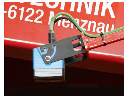
Une caméra Lldar 3D saisit les dimensions des tas. La grue parvient ainsi à se mouvoir sans collision dans cet environnement.
