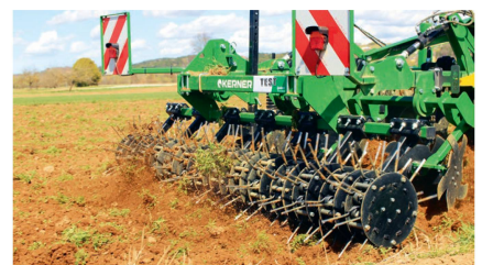
Le nouveau rouleau étrille rotatif s'avère efficace dans l'élimination des adventices.
