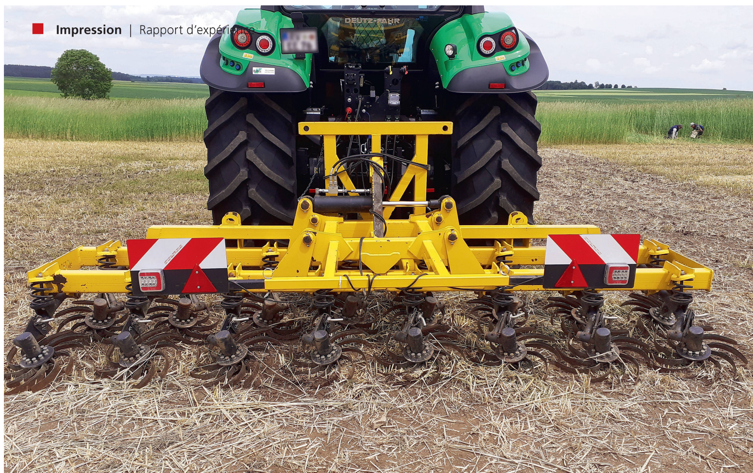
Ce désherbeur rotatif de la société Busa présente une largeur de travail de 4 mètres. Photos: Cedric Köster
