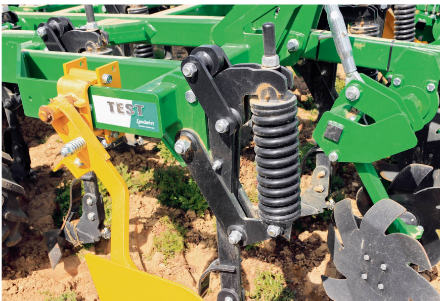
La sécurité anti-pierre mécanique a un seuil de déclenchement d'environ 800 kilos.
