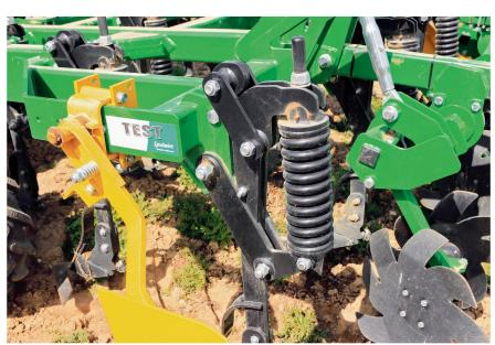
La sécurité anti-pierre mécanique a un seuil de déclenchement d'environ 800 kilos.
