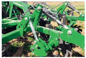
Le réglage hydraulique de la profondeur de travail et l'ajustement central des répartiteurs en étoile se font via une tige filetée.
