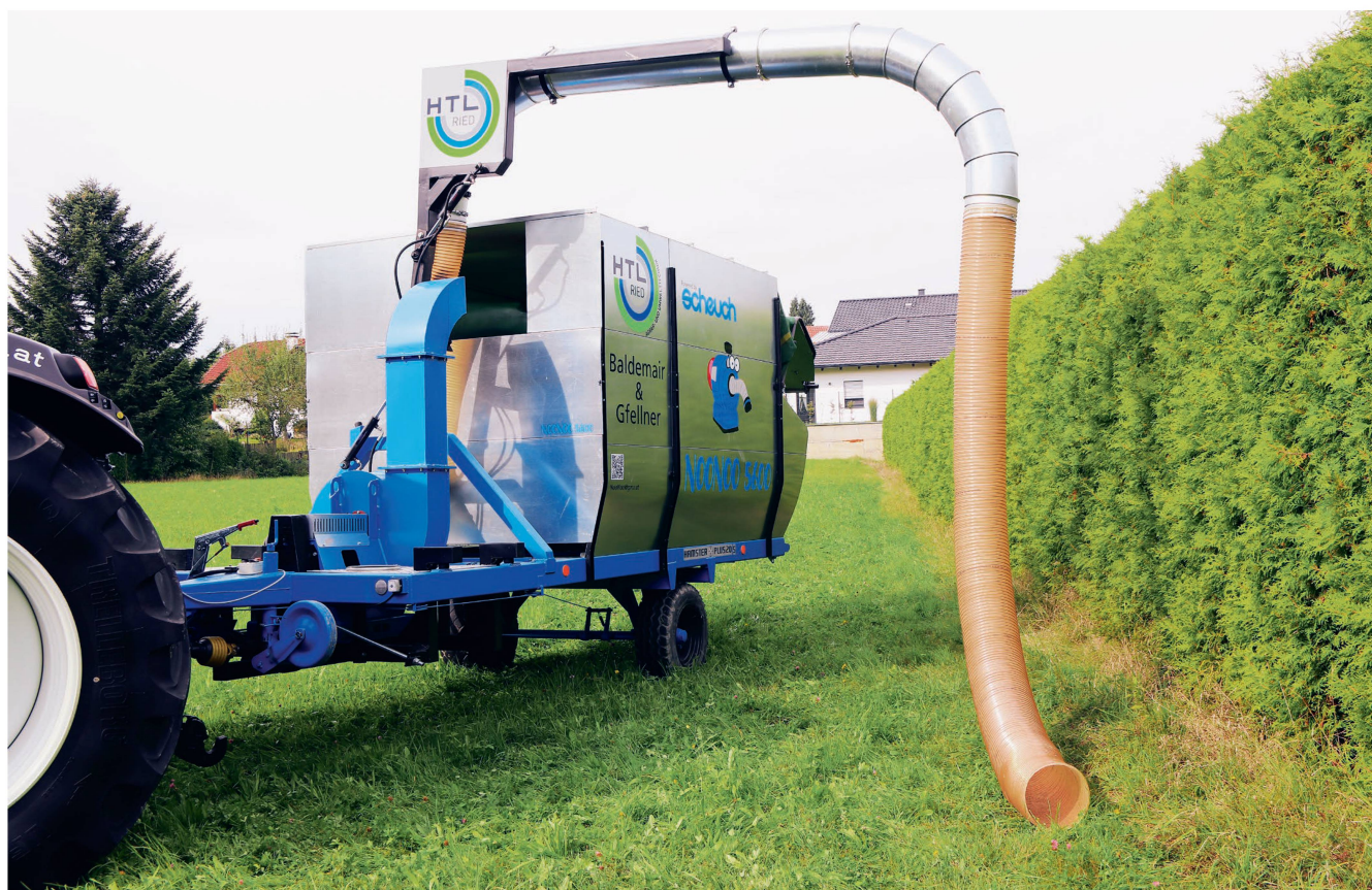
Le bras peut évoluer au-dessus de haies de 3,5 mètres de haut. Il se contrôle par une télécommande ou directement sur la machine.
