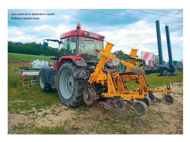
Les conditions idéales pour intervenir avec le rotor sont des sols légèrement ou modérément humides. Un excès d'humidité empêchera les lames de remplir leur fonction, car les sols deviennent très élastiques. Il n'y a cependant pas de risque de lissage du sol. Dans des conditions de sécheresse extrême, l'effet d'émiettement augmente, ainsi que la formation de poussière.
