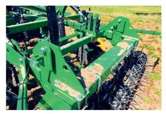
L'option châssis d'échange rapide sert aux rouleaux suiveurs.
