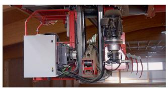
La griffe à fourrage autonome est équipée de la transmission à variation continue électrique «Power Drive+».
