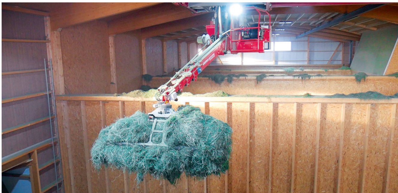
La grue saisit le fourrage sec de manière autonome et en transporte jusqu'à 40 mètres cubes dans le séchoir en dix minutes. Photos: Roman Engeler
