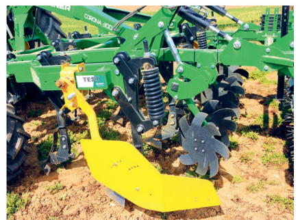
Les tôles de bordure assurent une bonne continuité sans formation de buttes.
