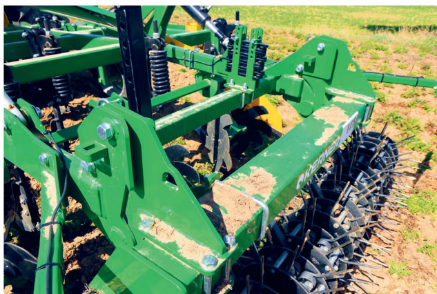
L'option châssis d'échange rapide sert aux rouleaux suiveurs.
