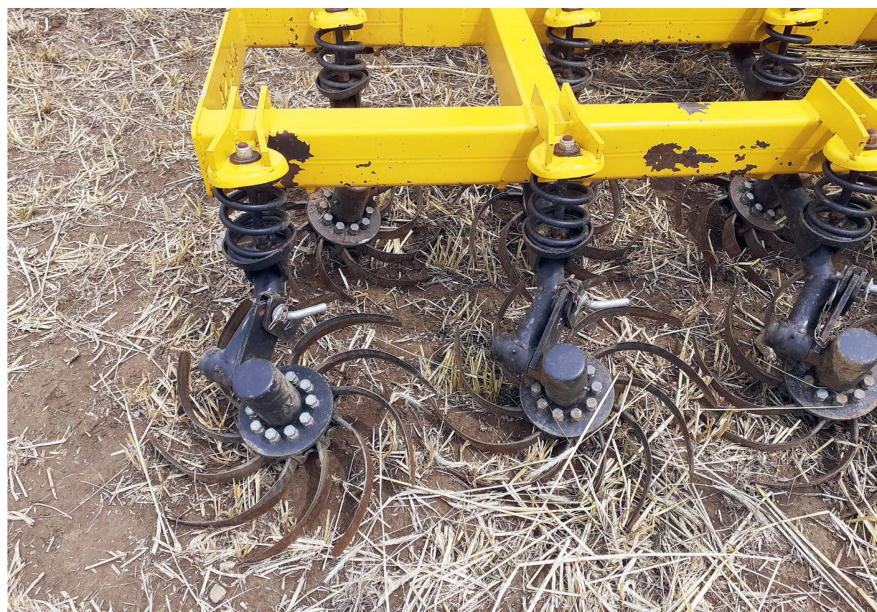
L'angle d'attaque de chaque rotor est réglé individuellement à l'aide d'une plaque munie d'une série de perforations et d'une broche.
