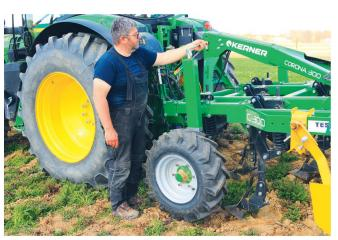
Les roues d'appui optionnelles permettent un meilleur guidage en profondeur. Pour procéder au réglage, il faut descendre du tracteur.
