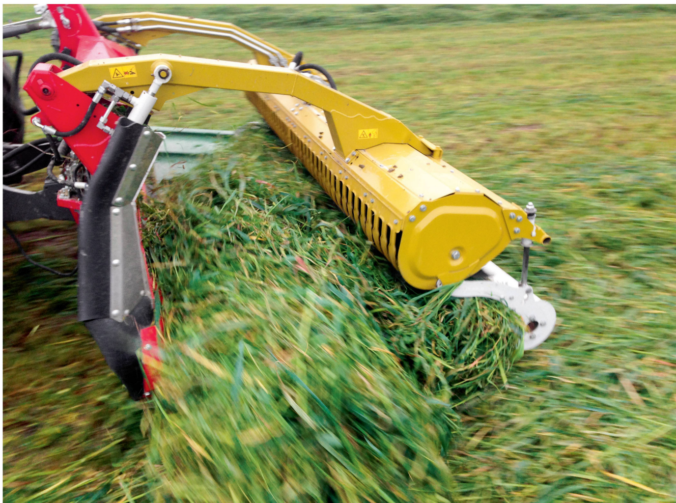
Avec les andaineurs à pick-up frontaux, le tracteur ne circule pas sur le fourrage et les pertes par brisure sont moins nombreuses. Photo: Reiter
