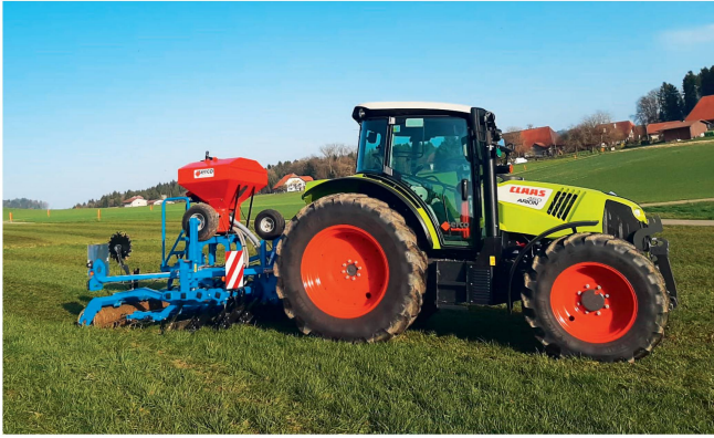
Les combinés d'entretien associent souvent un aplanisseur, une herse étrille, un rouleau et un semoir. Photo: Serco
