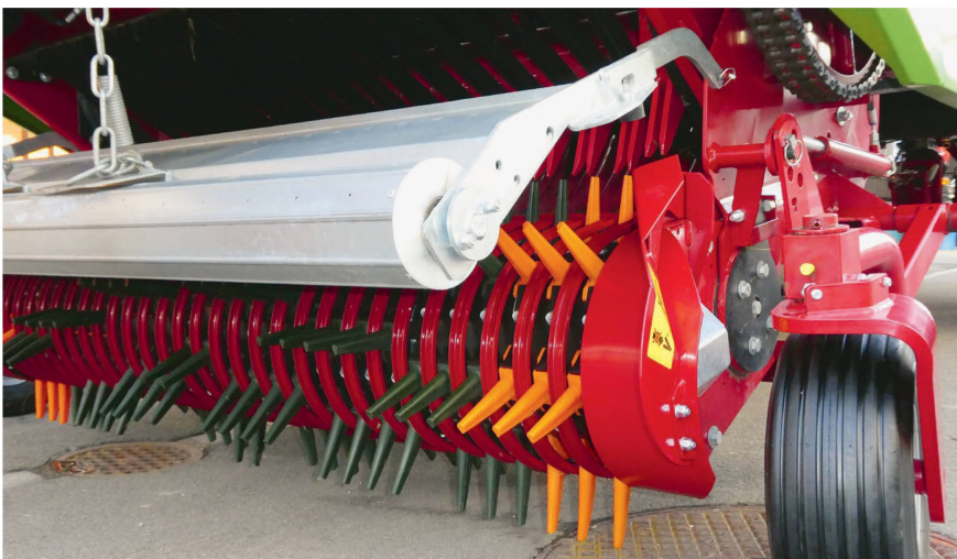
Les pick-ups réservent parfois des surprises. Le modèle hélicoïdal «flex load» à dents élastiques en matière synthétique est représenté ici. Photos: Ruedi Hunger
