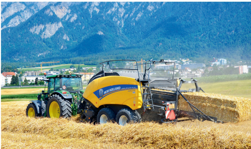
Voici un an, New Holland a présenté un système permettant de presser automatiquement des balles parallélépipédiques d'un poids défini à l'avance.
