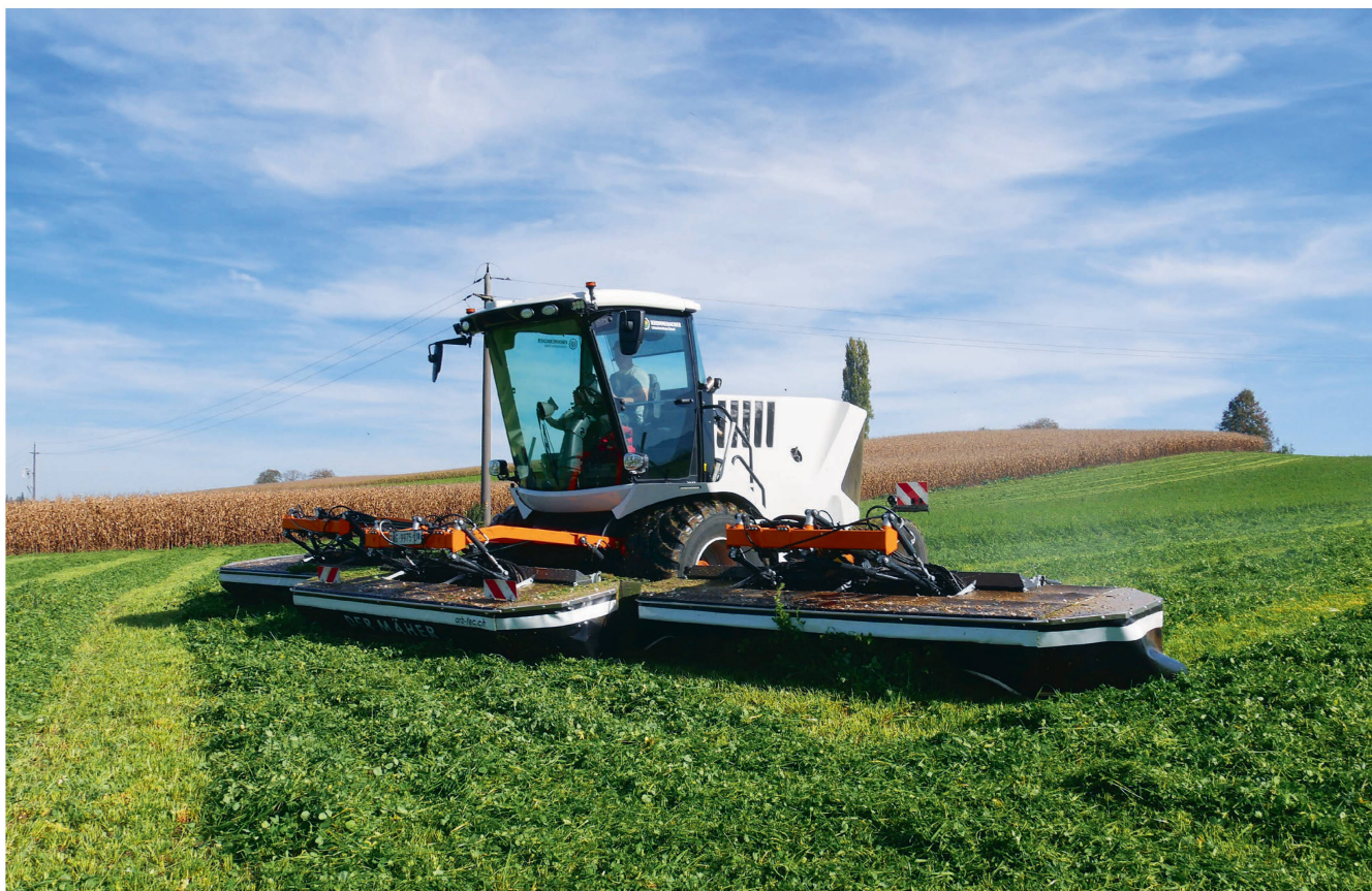
«Swiss Made», 8,5 tonnes de poids à vide, 350 chevaux, largeur de travail de 11 mètres: telles sont les caractéristiques-clés de la faucheuse automotrice «Cutaro». Photo: ARB-Tec AG
