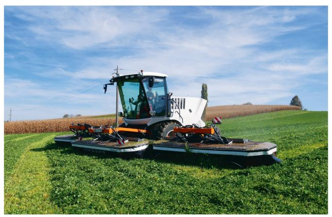
«Swiss Made», 8,5 tonnes de poids à vide, 350 chevaux, largeur de travail de 11 mètres: telles sont les caractéristiques-clés de la faucheuse automotrice «Cutaro». Photo: ARB-Tec AG
