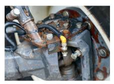
Le capteur en butée des roues avant, que Tobias Furrer a lui-même installé, désactive automatiquement la transmission intégrale.
