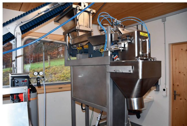
L'emballage constitue la dernière étape durant laquelle les cerneaux sont mis sous vide. Auparavant, nous vérifions soigneusement que tous les morceaux de coques ont été enlevés.
