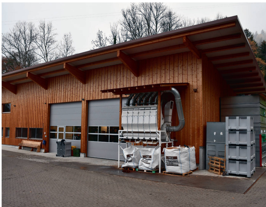
Le dispositif d'ensachage des coques de noix est au premier plan, devant le bâtiment qui abrite le centre de transformation de la coopérative Swissnuss.
