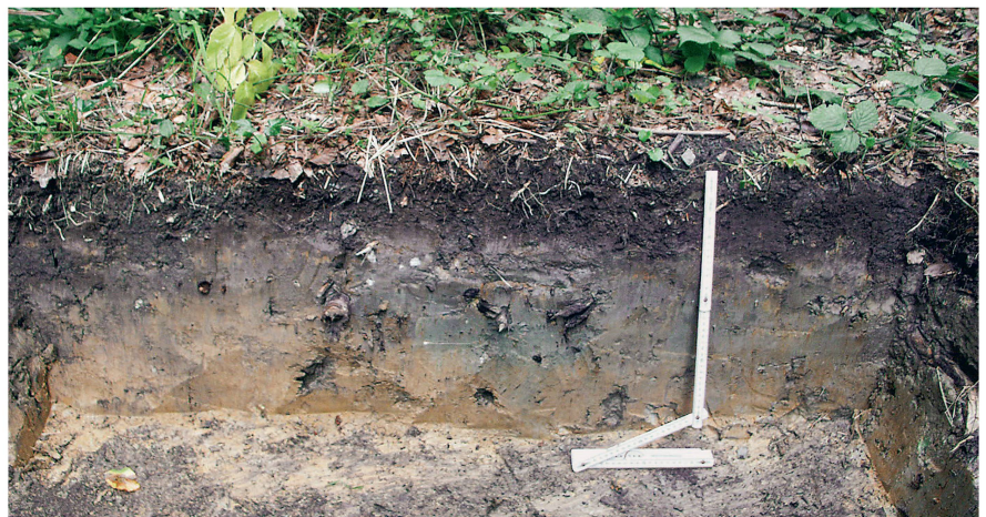
Ornière avec caractéristiques d'hydromorphie. Les couleurs de réduction (gris-bleu) et les taches de couleur rouille indiquent une aération restreinte du sol. Le passage d'engins est à l'origine de la réduction du volume des pores.
