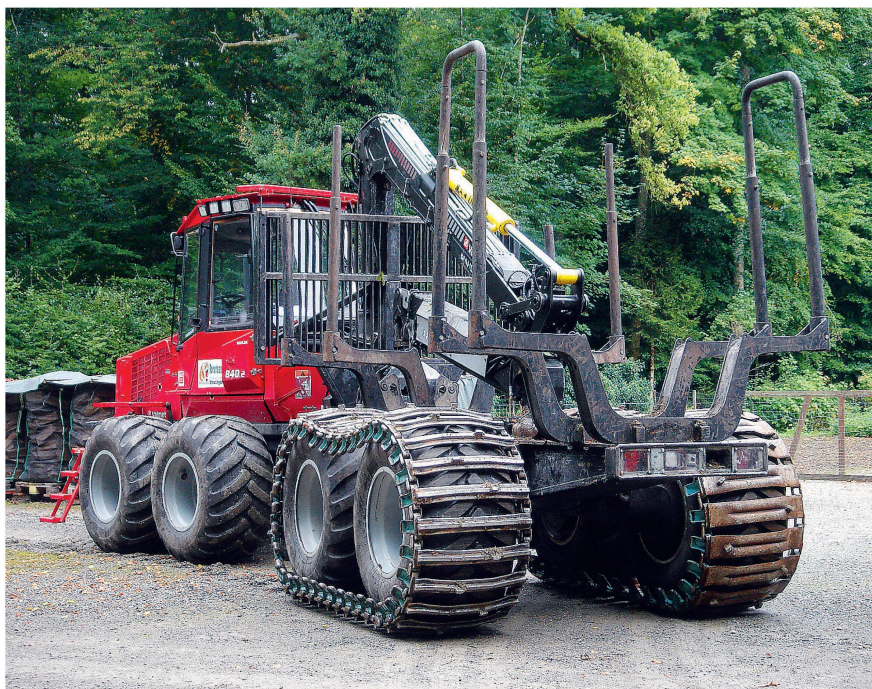
A des fins de démonstration, ce porteur a été équipé de deux types de semi-chenilles: à g. des semi-chenilles de traction destinées à améliorer les performances en montée et la sécurité en pente, à droite des semi-chenilles portantes permettant de préserver les sols à faible portance, sur terrains plats ou légèrement inclinés.
