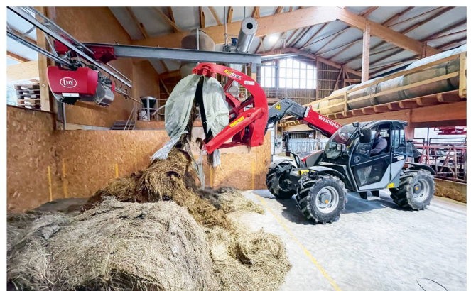
Les balles, prédécoupées dès la récolte, sont sectionnées en deux lors du désilage avec une pince de manutention spéciale, pour faciliter le travail du grappin.
