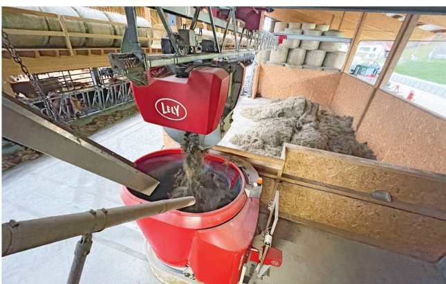
Les six rations complètes sont préparées lorsque le robot est connecté à sa borne de charge, près des silos et de la cuisine, dans lesquels sont stockés les différents ingrédients.
