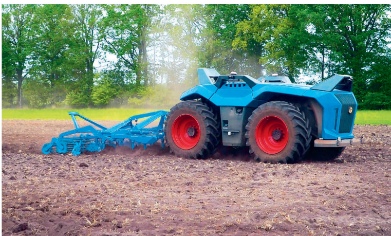
Dans l'étude du concept «Combined Powers», l'unité d'entraînement et l'accèssoire forment une entité autonome. Photo: VTE
