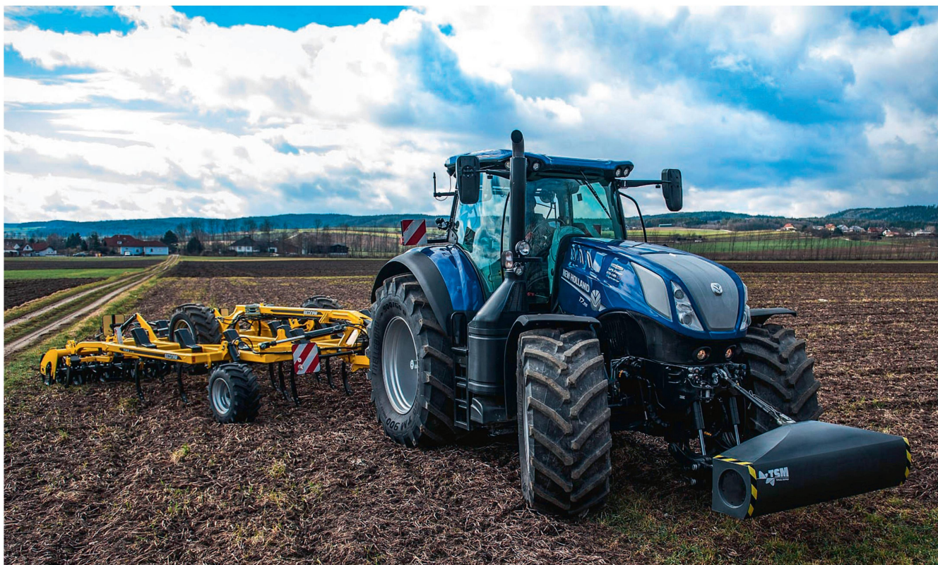
Le capteur de sol TSM («Soil Explorer») compatible Isobus s'utilise pour contrôler la profondeur de travail ou pour le semis modulé de la parcelle en temps réel. Photo: CNH
