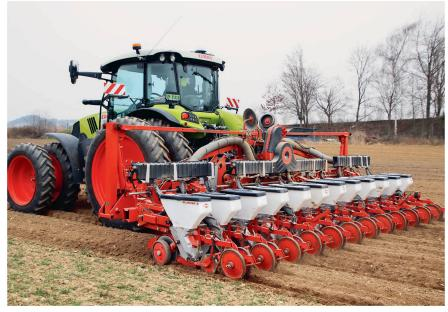
Le semis sans chevauchement avec la coupure de section est possible avec la numérisation.
