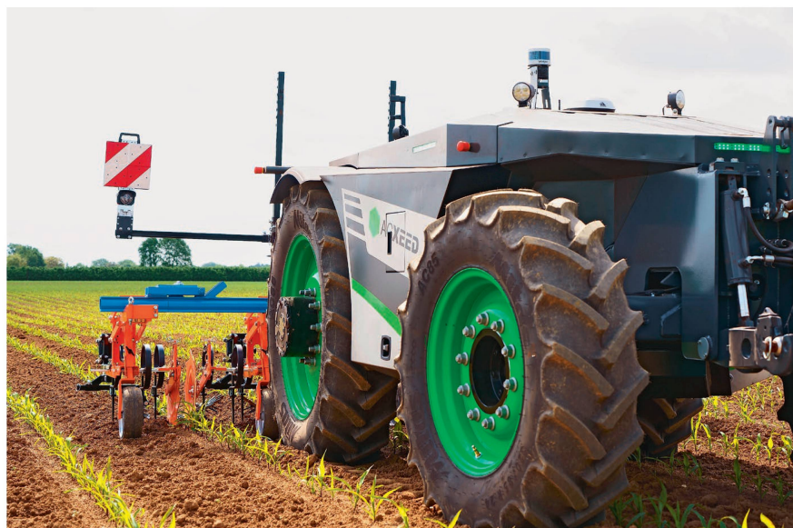
La numérisation poussée au plus haut point: véhicule autonome avec un outil de désherbage autonome. Photo: AgXeed
