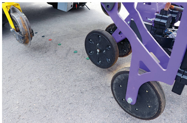
Feldklasse fait la démonstration du fonctionnement des couteaux sarcleurs commandés par caméra à l'aide de jetons de poker.
