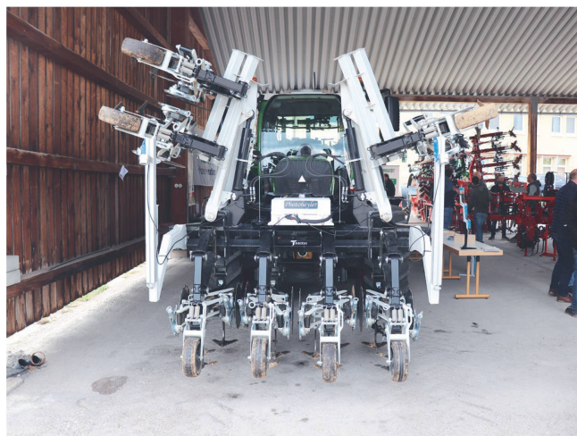
Sur le «VarioChop» de Samo, la largeur de travail des éléments peut être modifiée en un tournemain.
