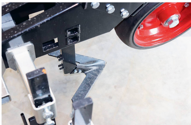
Lors du sarclage, il est important d'obtenir une coupe nette. C'est pourquoi de nombreux socs ont un angle de travail très plat.
