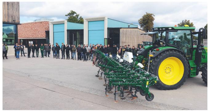
Démonstration de la fonction «coupure de section» sur une sarcleuse à commande hydraulique de Garford.
