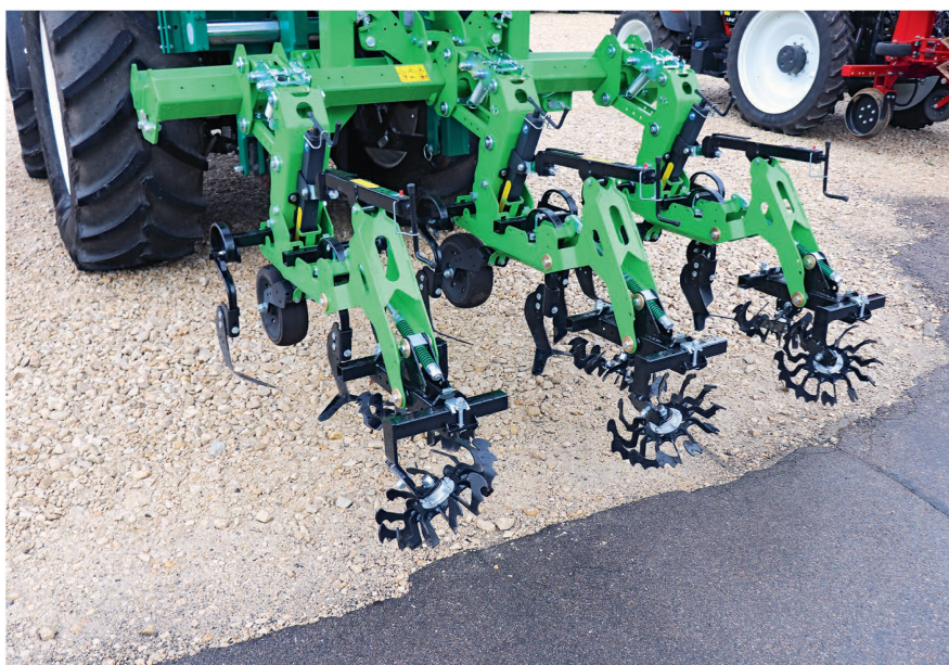
Les pièces travaillantes rotatives de Cavalleretti fonctionnent également sur le rang.
