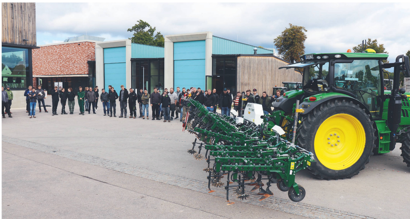
Démonstration de la fonction «coupe de section» sur une sarceuse à commande hydraulique de Garford.
