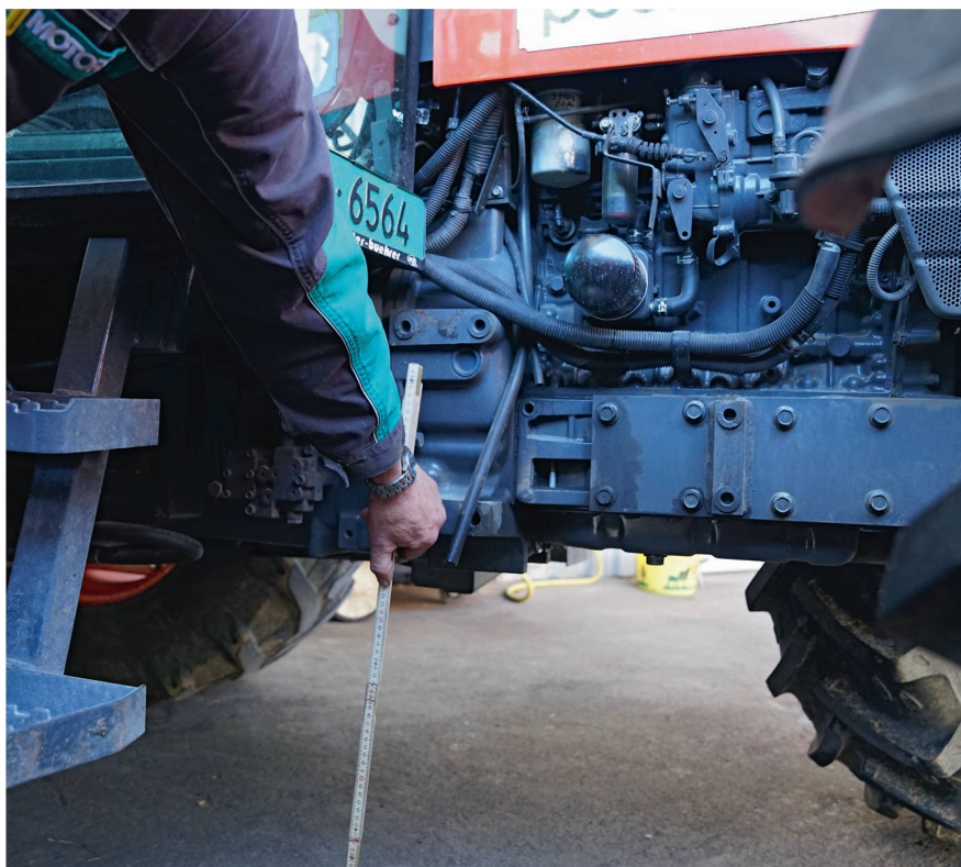
La garde au sol de 46 cm du Kubota «M135GX» est impressionnante.
