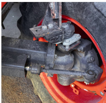
Le «M135GX» doit sa maniabilité à son faible rayon de braquage, lui-même tributaire de la transmission à pignons de l'essieu avant.
